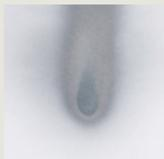
Ursache: Horn- und Stirnbohrungen verschmutzt, Luftkreisbohrung verschmutzt
